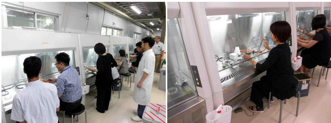
8号館の中に、微生物の取り扱いに適したクリーンベンチがあります。循環気流を用い、その一部を排気することにより、作業台から外部へ流出するのを防止します。微生物等の無菌操作と外部への飛散防止が行えます。先生方も一人一人交代で、植物体の洗浄、殺菌、置床の作業に取り組みました。
